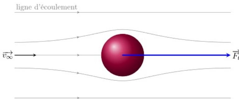
Dans la suite, on considère un corps solide plongé dans un milieu fluide avec une vitesse relative  $\mathcal{V}$ .
